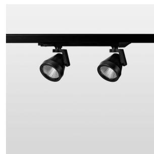
Aufbauleuchte mit zwei Lichtköpfen mit LED, Bemessungslebensdauer der LED L80/B10 > 50000 h, Farbwiedergabeindex CRI > 80, Farbortoleranz 2 SDCM (initial), rotationssymmetrischer Reflektor mit kreisförmigen Lichtbild, Reflektor Reinstaluminium 99,99% in MIRO-Silver®, segmentiert, Leuchtenkopf/Halteam Aluminium-Druckguss, schwarz, Drehwinkel 330°, Schwenkwinkel +/-85°, In-Track-Adapter, On/Off, 220-240 V~ / 50-60 Hz, max. Anzahl Leuchten pro Stromkreis 27 Stk. / B16A
