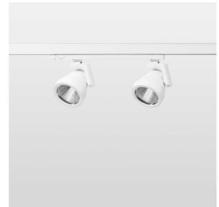
Aufbauleuchte mit zwei Lichtköpfen mit LED, Bemessungslebensdauer der LED L80/B10 > 50000 h, Farbwiedergabeindex CRI > 90, Farbortoleranz 2 SDCM (initial), rotationssymmetrischer Reflektor mit kreisförmigen Lichtbild, Reflektor Reinstaluminium 99,99% in MIRO-Silver®, segmentiert, Leuchtenkopf/Halteam Aluminium-Druckguss, weiß, Drehwinkel 330°, Schwenkwinkel +/-85°, In-Track-Adapter, On/Off, 220-240 V~ / 50-60 Hz, max. Anzahl Leuchten pro Stromkreis 27 Stk. / B16A
