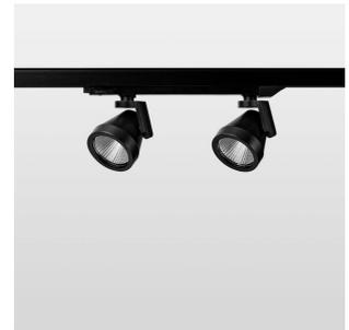
Aufbauleuchte mit zwei Lichtköpfen mit LED, Bemessungslebensdauer der LED L80/B10 > 50000 h, Farbwiedergabeindex CRI > 80, Farbortoleranz 2 SDCM (initial), rotationssymmetrischer Reflektor mit kreisförmigen Lichtbild, Reflektor Reinstaluminium 99,99% in MIRO-Silver®, segmentiert, Leuchtenkopf/Halteam Aluminium-Druckguss, schwarz, Drehwinkel 330°, Schwenkwinkel +/-85°, In-Track-Adapter, On/Off, 220-240 V~ / 50-60 Hz, max. Anzahl Leuchten pro Stromkreis 27 Stk. / B16A
