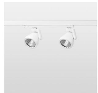
Aufbauleuchte mit zwei Lichtköpfen mit LED, Bemessungslebensdauer der LED L80/B10 > 50000 h, Farbwiedergabeindex CRI > 96, Farbortoleranz 2 SDCM (initial), rotationssymmetrischer Reflektor mit kreisförmigen Lichtbild, Reflektor Reinstaluminium 99,99% in MIRO-Silver®, segmentiert, Leuchtenkopf/Halteam Aluminium-Druckguss, weiß, Drehwinkel 330°, Schwenkwinkel +/-85°, In-Track-Adapter, On/Off, 220-240 V~ / 50-60 Hz, max. Anzahl Leuchten pro Stromkreis 27 Stk. / B16A
