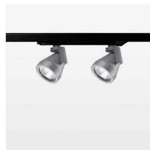
Aufbauleuchte mit zwei Lichtköpfen mit LED, Bemessungslebensdauer der LED L80/B10 > 50000 h, Farbwiedergabeindex CRI > 90, Farbortoleranz 2 SDCM (initial), rotationssymmetrischer Reflektor mit kreisförmigen Lichtbild, Reflektor Reinstaluminium 99,99% in MIRO-Silver®, segmentiert, Leuchtenkopf/Halteam Aluminium-Druckguss, silber, Drehwinkel 330°, Schwenkwinkel +/-85°, In-Track-Adapter, On/Off, 220-240 V~ / 50-60 Hz, max. Anzahl Leuchten pro Stromkreis 27 Stk. / B16A
