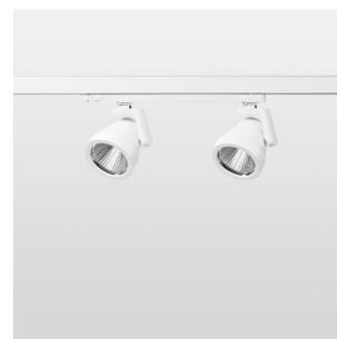
Aufbauleuchte mit zwei Lichtköpfen mit LED, Bemessungslebensdauer der LED L80/B10 > 50000 h, Farbwiedergabeindex CRI > 80, Farbortoleranz 2 SDCM (initial), rotationssymmetrischer Reflektor mit kreisförmigen Lichtbild, Reflektor Reinstaluminium 99,99% in MIRO-Silver®, segmentiert, Leuchtenkopf/Halteam Aluminium-Druckguss, weiß, Drehwinkel 330°, Schwenkwinkel +/-85°, In-Track-Adapter, On/Off, 220-240 V~ / 50-60 Hz, max. Anzahl Leuchten pro Stromkreis 27 Stk. / B16A
