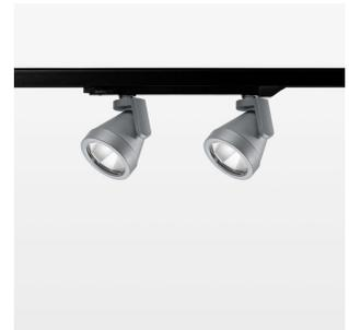
Aufbauleuchte mit zwei Lichtköpfen mit LED, Bemessungslebensdauer der LED L80/B10 > 50000 h, Farbwiedergabeindex CRI > 80, Farbortoleranz 2 SDCM (initial), rotationssymmetrischer Reflektor mit kreisförmigen Lichtbild, Reflektor Reinstaluminium 99,99% in MIRO-Silver®, segmentiert, Leuchtenkopf/Halteam Aluminium-Druckguss, silber, Drehwinkel 330°, Schwenkwinkel +/-85°, In-Track-Adapter, On/Off, 220-240 V~ / 50-60 Hz, max. Anzahl Leuchten pro Stromkreis 27 Stk. / B16A
