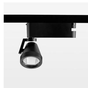
Aufbauleuchte mit LED, Bemessungslebensdauer der LED L80/B10 50000 h (Tambient 25°C), Farbwiedergabeindex CRI > 80, Farborttoleranz 2 SDCM (initial), Reflektor mit ovalem Lichtbild, Reflektor Reinstaluminium 99,99% in MIRO-Silver®, segmentiert, Leuchtenkopf/Haltearm Aluminium-Druckguss, pulverbeschichtet, schwarz, Drehwinkel 400°, Schwenkwinkel +/- 85°, Power-Adapter, On/Off, 220-240 V~ / 50-60 Hz, max. Anzahl Leuchten pro Stromkreis 22 Stk. / B16A
