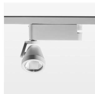
Aufbauleuchte mit LED, Bemessungslebensdauer der LED L80/B10 50000 h (Tambient 25°C), Farbwiedergabeindex CRI > 80, Farborttoleranz 2 SDCM (initial), Reflektor mit ovalem Lichtbild, Reflektor Reinstaluminium 99,99% in MIRO-Silver®, segmentiert, Leuchtenkopf/Haltearm Aluminium-Druckguss, pulverbeschichtet, weiß, Drehwinkel 400°, Schwenkwinkel +/- 85°, elektronischer Treiber: 220-240 V~ / 50-60 Hz, DALI, max. Anzahl Leuchten pro Stromkreis 50 Stk. / B16A
