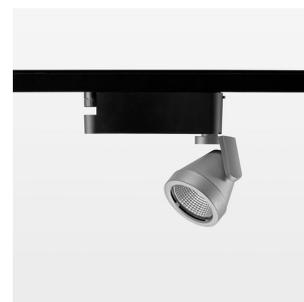
Aufbauleuchte mit LED, Bemessungslebensdauer der LED L80/B10 50000 h (Tambient 25°C), Farbwiedergabeindex CRI > 80, Farborttoleranz 2 SDCM (initial), Reflektor mit ovalem Lichtbild, Reflektor Reinstaluminium 99,99% in MIRO-Silver®, segmentiert, Leuchtenkopf/Haltearm Aluminium-Druckguss, pulverbeschichtet, silber, Drehwinkel 400°, Schwenkwinkel +/- 85°, Power-Adapter, DALI, 220-240 V~ / 50-60 Hz, max. Anzahl Leuchten pro Stromkreis 95 Stk. / B16A
