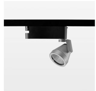
Aufbauleuchte mit LED, Bemessungslebensdauer der LED L80/B10 50000 h (Tambient 25°C), Farbwiedergabeindex CRI > 90, Farborttoleranz 2 SDCM (initial), Reflektor mit ovalem Lichtbild, Reflektor Reinstaluminium 99,99% in MIRO-Silver®, segmentiert, Leuchtenkopf/Haltearm Aluminium-Druckguss, pulverbeschichtet, silber, Drehwinkel 400°, Schwenkwinkel +/- 85°, Power-Adapter, Poti, 220-240 V~ / 50-60 Hz, max. Anzahl Leuchten pro Stromkreis 22 Stk. / B16A
