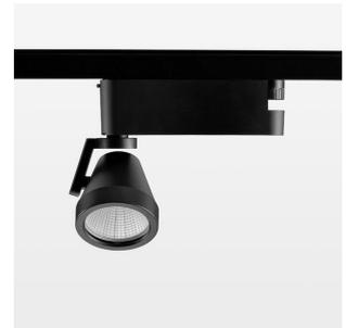
Aufbauleuchte mit LED, Bemessungslebensdauer der LED L80/B10 50000 h (Tambient 25°C), Farbwiedergabeindex CRI > 96, Farborttoleranz 2 SDCM (initial), rotationssymmetrischer Reflektor mit kreisförmigen Lichtbild, Reflektor Reinstaluminium 99,99% in MIRO-Silver®, segmentiert und facettiert, Leuchtenkopf/Haltearm Aluminium-Druckguss, pulverbeschichtet, schwarz, Drehwinkel 400°, Schwenkwinkel +/- 85°, Power-Adapter, On/Off, 220-240 V~ / 50-60 Hz, max. Anzahl Leuchten pro Stromkreis 22 Stk. / B16A
