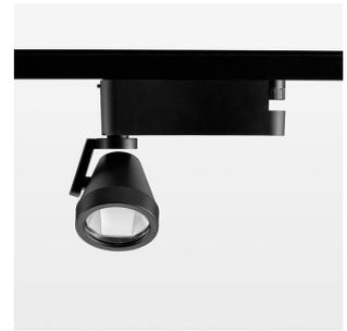
Aufbauleuchte mit LED, Bemessungslebensdauer der LED L80/B10 50000 h (Tambient 25°C), Farbwiedergabeindex CRI > 96, Farborttoleranz 2 SDCM (initial), Reflektor mit ovalem Lichtbild, Reflektor Reinstaluminium 99,99% in MIRO-Silver®, segmentiert, Leuchtenkopf/Haltearm Aluminium-Druckguss, pulverbeschichtet, schwarz, Drehwinkel 400°, Schwenkwinkel +/- 85°, Power-Adapter, Poti, 220-240 V~ / 50-60 Hz, max. Anzahl Leuchten pro Stromkreis 22 Stk. / B16A
