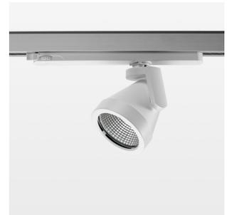
Aufbauleuchte mit LED, Bemessungslebensdauer der LED L80/B10 50000 h (Tambient 25°C), Farbwiedergabeindex CRI > 80, Farborttoleranz 2 SDCM (initial), rotationssymmetrischer Reflektor mit kreisförmigen Lichtbild, Reflektor Reinstaluminium 99,99% in MIRO-Silver®, Leuchtenkopf/Halteam Aluminium-Druckguss, pulverbeschichtet, weiß, Drehwinkel 330°, Schwenkwinkel +/- 85°, In-Track-Adapter, On/Off, 220-240 V~ / 50-60 Hz, max. Anzahl Leuchten pro Stromkreis 27 Stk. / B16A
