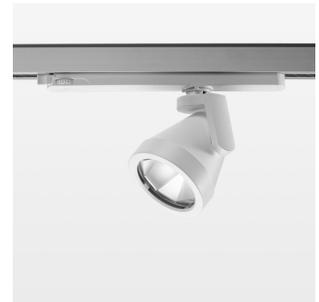
Aufbauleuchte mit LED, Bemessungslebensdauer der LED L80/B10 50000 h (Tambient 25°C), Farbwiedergabeindex CRI > 90, Farborttoleranz 2 SDCM (initial), Reflektor mit ovalem Lichtbild, Reflektor Reinstaluminium 99,99% in MIRO-Silver®, Leuchtenkopf/Halteam Aluminium-Druckguss, pulverbeschichtet, weiß, Drehwinkel 330°, Schwenkwinkel +/- 85°, In-Track-Adapter, On/Off, 220-240 V~ / 50-60 Hz, max. Anzahl Leuchten pro Stromkreis 27 Stk. / B16A
