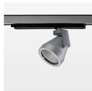
Aufbauleuchte mit LED, Bemessungslebensdauer der LED L80/B10 50000 h (Tambient 25°C), Farbwiedergabeindex CRI > 80, Farborttoleranz 2 SDCM (initial), rotationssymmetrischer Reflektor mit kreisförmigen Lichtbild, Reflektor Reinstaluminium 99,99% in MIRO-Silver®, Leuchtenkopf/Halteam Aluminium-Druckguss, pulverbeschichtet, silber, Drehwinkel 330°, Schwenkwinkel +/- 85°, In-Track-Adapter, On/Off, 220-240 V~ / 50-60 Hz, max. Anzahl Leuchten pro Stromkreis 27 Stk. / B16A
