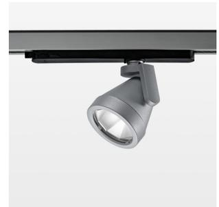
Aufbauleuchte mit LED, Bemessungslebensdauer der LED L80/B10 50000 h (Tambient 25°C), Farbwiedergabeindex CRI > 90, Farborttoleranz 2 SDCM (initial), Reflektor mit ovalem Lichtbild, Reflektor Reinstaluminium 99,99% in MIRO-Silver®, Leuchtenkopf/Haltearm Aluminium-Druckguss, pulverbeschichtet, silber, Drehwinkel 330°, Schwenkwinkel +/- 85°, In-Track-Adapter, On/Off, 220-240 V~ / 50-60 Hz, max. Anzahl Leuchten pro Stromkreis 27 Stk. / B16A
