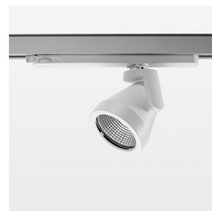
Aufbauleuchte mit LED, Bemessungslebensdauer der LED L80/B10 50000 h (Tambient 25°C), Farbwiedergabeindex CRI > 80, Farborttoleranz 2 SDCM (initial), rotationssymmetrischer Reflektor mit kreisförmigen Lichtbild, Reflektor Reinstaluminium 99,99% in MIRO-Silver®, Leuchtenkopf/Halteam Aluminium-Druckguss, pulverbeschichtet, weiß, Drehwinkel 330°, Schwenkwinkel +/- 85°, In-Track-Adapter, On/Off, 220-240 V~ / 50-60 Hz, max. Anzahl Leuchten pro Stromkreis 27 Stk. / B16A
