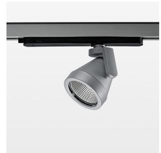
Aufbauleuchte mit LED, Bemessungslebensdauer der LED L80/B10 50000 h (Tambient 25°C), Farbwiedergabeindex CRI > 90, Farborttoleranz 2 SDCM (initial), rotationssymmetrischer Reflektor mit kreisförmigen Lichtbild, Reflektor Reinstaluminium 99,99% in MIRO-Silver®, Leuchtenkopf/Halteam Aluminium-Druckguss, pulverbeschichtet, silber, Drehwinkel 330°, Schwenkwinkel +/- 85°, In-Track-Adapter, On/Off, 220-240 V~ / 50-60 Hz, max. Anzahl Leuchten pro Stromkreis 27 Stk. / B16A
