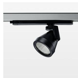
Aufbauleuchte mit LED, Bemessungslebensdauer der LED L80/B10 50000 h (Tambient 25°C), Farbwiedergabeindex CRI > 80, Farborttoleranz 2 SDCM (initial), rotationssymmetrischer Reflektor mit kreisförmigen Lichtbild, Reflektor Reinstaluminium 99,99% in MIRO-Silver®, Leuchtenkopf/Halteam Aluminium-Druckguss, pulverbeschichtet, schwarz, Drehwinkel 330°, Schwenkwinkel +/- 85°, In-Track-Adapter, On/Off, 220-240 V~ / 50-60 Hz, max. Anzahl Leuchten pro Stromkreis 27 Stk. / B16A
