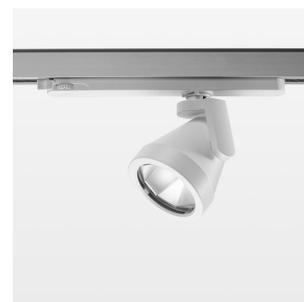
Aufbauleuchte mit LED, Bemessungslebensdauer der LED L80/B10 50000 h (Tambient 25°C), Farbwiedergabeindex CRI > 90, Farborttoleranz 2 SDCM (initial), Reflektor mit ovalem Lichtbild, Reflektor Reinstaluminium 99,99% in MIRO-Silver®, Leuchtenkopf/Halterarm Aluminium-Druckguss, pulverbeschichtet, weiß, Drehwinkel 330°, Schwenkwinkel +/- 85°, In-Track-Adapter, On/Off, 220-240 V~ / 50-60 Hz, max. Anzahl Leuchten pro Stromkreis 27 Stk. / B16A
