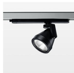
Aufbauleuchte mit LED, Bemessungslebensdauer der LED L80/B10 50000 h (Tambient 25°C), Farbwiedergabeindex CRI > 80, Farborttoleranz 2 SDCM (initial), Reflektor mit ovalem Lichtbild, Reflektor Reinstaluminium 99,99% in MIRO-Silver®, Leuchtenkopf/Haltearm Aluminium-Druckguss, pulverbeschichtet, schwarz, Drehwinkel 330°, Schwenkwinkel +/- 85°, In-Track-Adapter, On/Off, 220-240 V~ / 50-60 Hz, max. Anzahl Leuchten pro Stromkreis 27 Stk. / B16A
