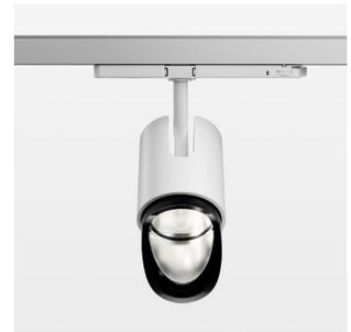
Aufbauleuchte mit LED, Bemessungslebensdauer der LED L80/B10 50000 h (Tambient 25°C), Farbwiedergabeindex CRI > 95, Farborttoleranz 2 SDCM (initial), Reflektor mit asymmetrischem Lichtbild, Reflektor Reinstaluminium 99,99% in MIRO-Silver®, Leuchtenkopf/Halteam Aluminium-Druckguss, weiß, Drehwinkel 330°, Schwenkwinkel +/- 90°, In-Track-Adapter (OT), DALI 2, 220-240 V~ / 50-60 Hz, max. Anzahl Leuchten pro Stromkreis 27 Stk. / B16A
