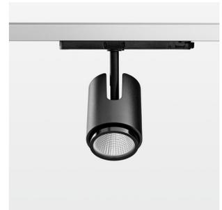
Aufbauleuchte mit LED, Bemessungslebensdauer der LED L80/B10 50000 h (Tambient 25°C), Farbwiedergabeindex CRI > 80, Farborttoleranz 3 SDCM (initial), rotationssymmetrischer Reflektor mit kreisförmigen Lichtbild, Reflektor Reinstaluminium 99,99% in MIRO-Silver®, Leuchtenkopf/Halteam Aluminium-Druckguss, schwarz, Drehwinkel 330°, Schwenkwinkel +/- 90°, In-Track-Adapter (OT), DALI 2, 220-240 V~ / 50-60 Hz, max. Anzahl Leuchten pro Stromkreis 27 Stk. / B16A
