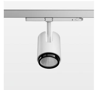
Aufbauleuchte mit LED, Bemessungslebensdauer der LED L80/B10 50000 h (Tambient 25°C), Farbwiedergabeindex CRI > 80, Farborttoleranz 3 SDCM (initial), rotationssymmetrischer Reflektor mit kreisförmigen Lichtbild, Reflektor Reinstaluminium 99,99% in MIRO-Silver®, Leuchtenkopf/Halteam Aluminium-Druckguss,, weiß, Drehwinkel 330°, Schwenkwinkel +/- 90°, In-Track-Adapter (OT), DALI 2, 220-240 V~ / 50-60 Hz, max. Anzahl Leuchten pro Stromkreis 27 Stk. / B16A
