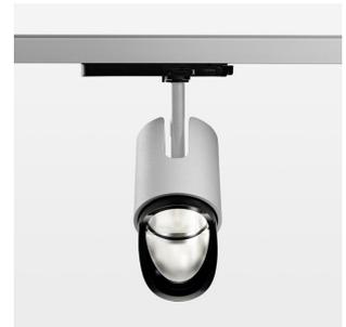
Aufbauleuchte mit LED, Bemessungslebensdauer der LED L80/B10 50000 h (Tambient 25°C), Farbwiedergabeindex CRI > 95, Farborttoleranz 2 SDCM (initial), Reflektor mit asymmetrischem Lichtbild, Reflektor Reinstaluminium 99,99% in MIRO-Silver®, Leuchtenkopf/Halteam Aluminium-Druckguss, silber, Drehwinkel 330°, Schwenkwinkel +/- 90°, In-Track-Adapter (OT), DALI 2, 220-240 V- / 50-60 Hz, max. Anzahl Leuchten pro Stromkreis 27 Stk. / B16A
