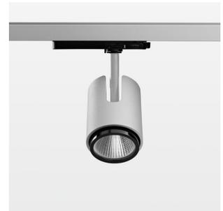
Aufbauleuchte mit LED, Bemessungslebensdauer der LED L80/B10 50000 h (Tambient 25°C), Farbwiedergabeindex CRI > 82, Farborttoleranz 2 SDCM (initial), rotationssymmetrischer Reflektor mit kreisförmigen Lichtbild, Primärreflektor und Kickreflektor Reinstaluminium 99,99% in MIRO-Silver®, Leuchtenkopf/Halteam Aluminium-Druckguss, pulverbeschichtet, silber, Drehwinkel 330°, Schwenkwinkel +/- 90°, In-Track-Adapter, Casambi, 220-240 V~ / 50-60 Hz, max. Anzahl Leuchten pro Stromkreis 64 Stk. / B16A
