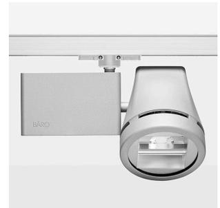
Aufbauleuchte mit LED, Bemessungslebensdauer der LED L80/B10 50000 h (Tambient 25°C), Farbwiedergabeindex CRI > 80, Farborttoleranz 3 SDCM (initial), Reflektor mit doppelt asymmetrischem Lichtbild, Reflektor Reinstaluminium 99,99% in MIRO-Silver®, Leuchtgehäuse/Kopf Aluminium-Druckguss, silber, Drehwinkel 350°, Schwenkwinkel 210°, Multiadapter, elektronischer Treiber: 220-240 V~ / 50-60 Hz, On/Off, max. Anzahl Leuchten pro Stromkreis 52 Stk. / B16A
