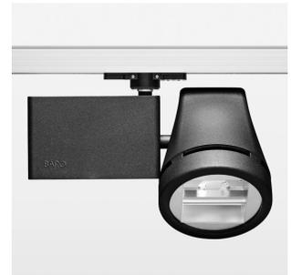
Aufbauleuchte mit LED, Bemessungslebensdauer der LED L80/B10 50000 h (Tambient 25°C), Farbwiedergabeindex CRI > 80, Farborttoleranz 3 SDCM (initial), Reflektor mit doppelt asymmetrischem Lichtbild, Reflektor Reinstaluminium 99,99% in MIRO-Silver®, Leuchtgehäuse/Kopf Aluminium-Druckguss, schwarz, Drehwinkel 350°, Schwenkwinkel 210°, Multiadapter, elektronischer Treiber: 220-240 V~ / 50-60 Hz, On/Off, max. Anzahl Leuchten pro Stromkreis 52 Stk. / B16A
