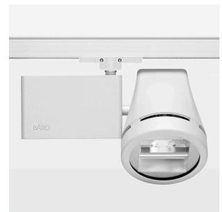
Aufbauleuchte mit LED, Bemessungslebensdauer der LED L80/B10 50000 h (Tambient 25°C), Farbwiedergabeindex CRI > 80, Farborttoleranz 3 SDCM (initial), Reflektor mit doppelt asymmetrischem Lichtbild, Reflektor Reinstaluminium 99,99% in MIRO-Silver®, Leuchtgehäuse/Kopf Aluminium-Druckguss, weiß, Drehwinkel 350°, Schwenkwinkel 210°, Multiadapter, elektronischer Treiber: 220-240 V~ / 50-60 Hz, On/Off, max. Anzahl Leuchten pro Stromkreis 52 Stk. / B16A
