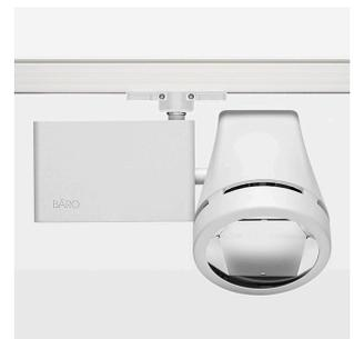
Aufbauleuchte mit LED, Bemessungslebensdauer der LED L80/B10 50000 h (Tambient 25°C), Farbwiedergabeindex CRI > 82, Farborttoleranz 2 SDCM (initial), Reflektor mit ovalem Lichtbild, Reflektor Reinstaluminium 99,99% in MIRO-Silver®, Leuchtengehäuse Aluminium-Druckguss, pulverbeschichtet, weiß, Drehwinkel 350°, Schwenkwinkel 210°, Multiadapter, DALI, max. Anzahl Leuchten pro Stromkreis 20 Stk. / B16A
