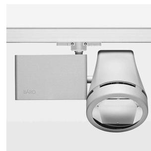
Aufbauleuchte mit LED, Bemessungslbensdauer der LED L80/B10 50000 h (Tambient 25°C), Farbwiedergabeindex CRI > 80, Farborttoleranz 3 SDCM (initial), Reflektor mit ovalem Lichtbild, Reflektor Reinstaluminium 99,99% in MIRO-Silver®, Leuchtgehäuse Aluminium-Druckguss, pulverbeschichtet, silber, Drehwinkel 350°, Schwenkwinkel 210°, Multiadapter, DALI, max. Anzahl Leuchten pro Stromkreis 20 Stk. / B16A
