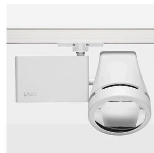
Aufbauleuchte mit LED, Bemessungslebensdauer der LED L80/B10 50000 h (Tambient 25°C), Farbwiedergabeindex CRI > 80, Farborttoleranz 2 SDCM (initial), Reflektor mit ovalem Lichtbild, Reflektor Reinstaluminium 99,99% in MIRO-Silver®, Leuchtengehäuse Aluminium-Druckguss, pulverbeschichtet, weiß, Drehwinkel 350°, Schwenkwinkel 210°, Multiadapter, DALI, 220-240 V, 50/60 Hz, max. Anzahl Leuchten pro Stromkreis 24 Stk. / B16A
