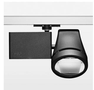
Aufbauleuchte mit LED, Bemessungslebensdauer der LED L80/B10 50000 h (Tambient 25°C), Farbwiedergabeindex CRI > 82, Farborttoleranz 2 SDCM (initial), Reflektor mit ovalem Lichtbild, Reflektor Reinstaluminium 99,99% in MIRO-Silver®, Leuchtengehäuse Aluminium-Druckguss, pulverbeschichtet, schwarz, Drehwinkel 350°, Schwenkwinkel 210°, Multiadapter, On/Off, 220-240 V, 50/60 Hz, max. Anzahl Leuchten pro Stromkreis 24 Stk. / B16A
