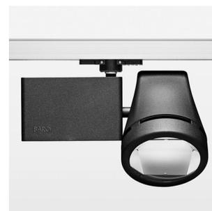
Aufbauleuchte mit LED, Bemessungslebensdauer der LED L80/B10 50000 h (Tambient 25°C), Farbwiedergabeindex CRI > 80, Farborttoleranz 2 SDCM (initial), Reflektor mit ovalem Lichtbild, Reflektor Reinstaluminium 99,99% in MIRO-Silver®, Leuchtengehäuse Aluminium-Druckguss, pulverbeschichtet, schwarz, Drehwinkel 350°, Schwenkwinkel 210°, Multiadapter, On/Off, 220-240 V, 50/60 Hz, max. Anzahl Leuchten pro Stromkreis 24 Stk. / B16A
