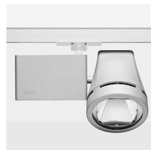
Aufbauleuchte mit LED, Bemessungslebensdauer der LED L80/B10 50000 h (Tambient 25°C), Farbwiedergabeindex CRI > 80, Farborttoleranz 2 SDCM (initial), rotationssymmetrischer Reflektor mit kreisförmigen Lichtbild, Reflektor Reinstaluminium 99,99% in MIRO-Silver®, Leuchtgehäuse Aluminium-Druckguss, pulverbeschichtet, silber, Drehwinkel 350°, Schwenkwinkel 210°, Multiadapter, On/Off, 220-240 V, 50/60 Hz, max. Anzahl Leuchten pro Stromkreis 24 Stk. / B16A
