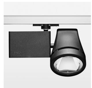
Aufbauleuchte mit LED, Bemessungslebensdauer der LED L80/B10 50000 h (Tambient 25°C), Farbwiedergabeindex CRI > 80, Farborttoleranz 2 SDCM (initial), Reflektor mit kreisförmigem Lichtbild, Reflektor Reinstaluminium 99,99% in MIRO-Silver®, Leuchtgehäuse Aluminium-Druckguss, pulverbeschichtet, schwarz, Drehwinkel 350°, Schwenkwinkel 210°, Multiadapter, On/Off, max. Anzahl Leuchten pro Stromkreis 34 Stk. / B16A
