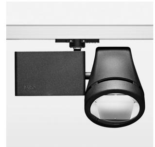
Aufbauleuchte mit LED, Bemessungslebensdauer der LED L80/B10 50000 h (Tambient 25°C), Farbwiedergabeindex CRI > 90, Farborttoleranz 2 SDCM (initial), Reflektor mit ovalem Lichtbild, Reflektor Reinstaluminium 99,99% in MIRO-Silver®, Leuchtengehäuse Aluminium-Druckguss, pulverbeschichtet, schwarz, Drehwinkel 350°, Schwenkwinkel 210°, Multiadapter, DALI, 220-240 V, 50/60 Hz, max. Anzahl Leuchten pro Stromkreis 24 Stk. / B16A
