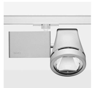
Aufbauleuchte mit LED, Bemessungslebensdauer der LED L80/B10 50000 h (Tambient 25°C), Farbwiedergabeindex CRI > 80, Farborttoleranz 2 SDCM (initial), rotationssymmetrischer Reflektor mit kreisförmigen Lichtbild, Reflektor Reinstaluminium 99,99% in MIRO-Silver®, Leuchtgehäuse Aluminium-Druckguss, pulverbeschichtet, silber, Drehwinkel 350°, Schwenkwinkel 210°, Multiadapter, DALI, max. Anzahl Leuchten pro Stromkreis 20 Stk. / B16A
