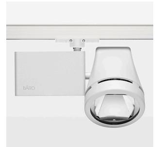
Aufbauleuchte mit LED, Bemessungslbensdauer der LED L80/B10 50000 h (Tambient 25°C), Farbwiedergabeindex CRI > 90, Farborttoleranz 2 SDCM (initial), Reflektor mit kreisförmigem Lichtbild, Reflektor Reinstaluminium 99,99% in MIRO-Silver®, Leuchtgehäuse Aluminium-Druckguss, pulverbeschichtet, weiß, Drehwinkel 350°, Schwenkwinkel 210°, Multiadapter, On/Off, max. Anzahl Leuchten pro Stromkreis 34 Stk. / B16A
