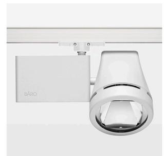
Aufbauleuchte mit LED, Bemessungslbensdauer der LED L80/B10 50000 h (Tambient 25°C), Farbwiedergabeindex CRI > 90, Farborttoleranz 2 SDCM (initial), Reflektor mit kreisförmigem Lichtbild, Reflektor Reinstaluminium 99,99% in MIRO-Silver®, Leuchtgehäuse Aluminium-Druckguss, pulverbeschichtet, weiß, Drehwinkel 350°, Schwenkwinkel 210°, Multiadapter, On/Off, 220-240 V, 50/60 Hz, max. Anzahl Leuchten pro Stromkreis 24 Stk. / B16A
