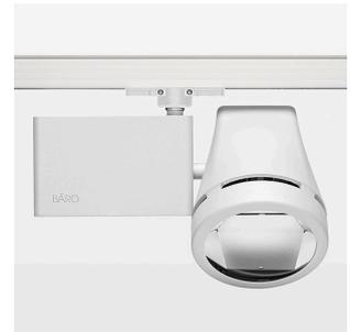
Aufbauleuchte mit LED, Bemessungslbensdauer der LED L80/B10 50000 h (Tambient 25°C), Farbwiedergabeindex CRI > 80, Farborttoleranz 2 SDCM (initial), Reflektor mit ovalem Lichtbild, Reflektor Reinstaluminium 99,99% in MIRO-Silver®, Leuchtgehäuse Aluminium-Druckguss, pulverbeschichtet, weiß, Drehwinkel 350°, Schwenkwinkel 210°, Multiadapter, DALI, max. Anzahl Leuchten pro Stromkreis 20 Stk. / B16A
