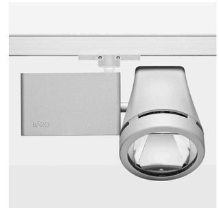
Aufbauleuchte mit LED, Bemessungslbensdauer der LED L80/B10 50000 h (Tambient 25°C), Farbwiedergabeindex CRI > 80, Farborttoleranz 2 SDCM (initial), rotationssymmetrischer Reflektor mit kreisförmigen Lichtbild, Reflektor Reinstaluminium 99,99% in MIRO-Silver®, Leuchtgehäuse Aluminium-Druckguss, pulverbeschichtet, silber, Drehwinkel 350°, Schwenkwinkel 210°, Multiadapter, DALI, 220-240 V, 50/60 Hz, max. Anzahl Leuchten pro Stromkreis 24 Stk. / B16A
