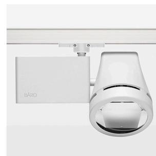
Aufbauleuchte mit LED, Bemessungslebensdauer der LED L80/B10 50000 h (Tambient 25°C), Farbwiedergabeindex CRI > 80, Farborttoleranz 2 SDCM (initial), Reflektor mit ovalem Lichtbild, Reflektor Reinstaluminium 99,99% in MIRO-Silver®, Leuchtengehäuse Aluminium-Druckguss, pulverbeschichtet, weiß, Drehwinkel 350°, Schwenkwinkel 210°, Multiadapter, DALI, max. Anzahl Leuchten pro Stromkreis 20 Stk. / B16A
