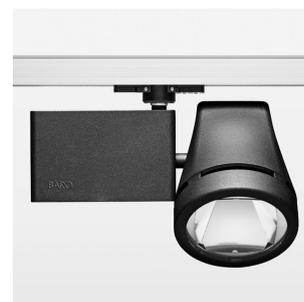
Aufbauleuchte mit LED, Bemessungslebensdauer der LED L80/B10 50000 h (Tambient 25°C), Farbwiedergabeindex CRI > 82, Farborttoleranz 2 SDCM (initial), Reflektor mit kreisförmigem Lichtbild, Reflektor Reinstaluminium 99,99% in MIRO-Silver®, Leuchtgehäuse Aluminium-Druckguss, pulverbeschichtet, schwarz, Drehwinkel 350°, Schwenkwinkel 210°, Multiadapter, DALI, max. Anzahl Leuchten pro Stromkreis 20 Stk. / B16A
