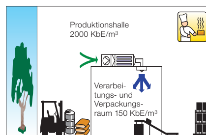
Installation des Moduls AirStream C zur Keiminaktivierung
