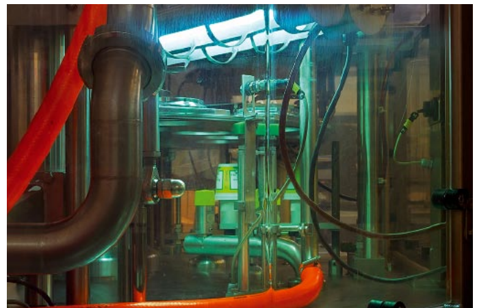
Wirkungsvolle Entkeimung von Innenräumen und Packungen im Rundfüller für Creme-Puddings und Zaziki
