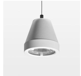
Pendelleuchte mit LED, Bemessungslebensdauer der LED L80/B10 > 50000 h, Farbwiedergabeindex CRI > 80, Farborttoleranz 3 SDCM (initial), rotationssymmetrischer Reflektor mit kreisförmigen Lichtbild, Reflektor Reinstaluminium 99,99% in MIRO-Silver®, segmentiert und facettiert, 3D-Linse Silikon, zur Reduzierung des Streulichtanteils, Leuchtenkopf Aluminium-Druckguss, pulverbeschichtet, Weiss, , On/Off, max. Anzahl Leuchten pro Stromkreis 104 Stk. / B16A
