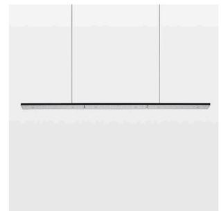
Pendelleuchte mit LED, Bemessungslebensdauer der LED L90/B50 50000 h (Tambient 25°C), Farbwiedergabeindex CRI > 80, Farborttoleranz 3 SDCM (initial), doppelt asymmetrisches Lichtbild mit deutlich erhöhter horizontaler Aufhellung, Kombination aus asymmetrischen PMMA Linsen und 30° TIR Linsen aus PMMA, Leuchtgehäuse Stahlblech, pulverbeschichtet, schwarz matt, Stromführung über Abhängeseile
