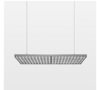
Pendelleuchte mit LED, Bemessungslebensdauer der LED L90/B50 50000 h (Tambient 25°C), Farbwiedergabeindex CRI > 80, Farborttoleranz 3 SDCM (initial), doppelt asymmetrisches Lichtbild mit deutlich erhöhter horizontaler Aufhellung, Linse aus PMMA, Leuchtgehäuse Stahlblech, pulverbeschichtet, silber matt, Stromführung über Abhängeseile, Baldachin / Einspeiseset (E-Set) bitte separat bestellen.
